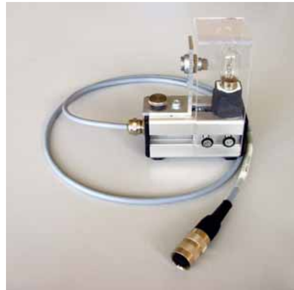
Glühbirne mit Temperatursensor als experimentelle Regelstrecke
