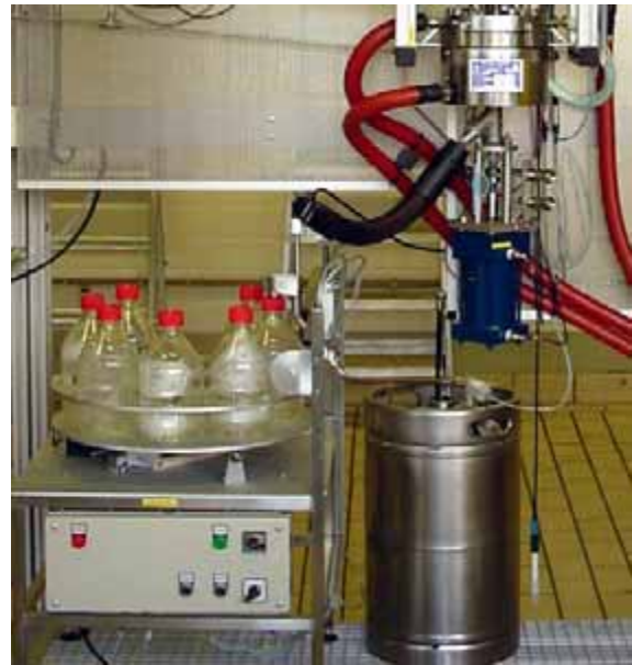
AutoSam-XL mit 8 2000ml-Flaschen am Druckreaktor
