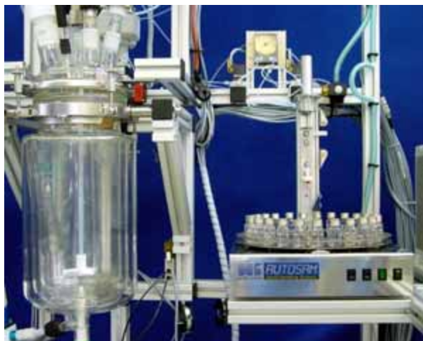
AutoSam300 als vollintegrierter Prozessbestandteil
