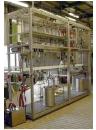
LabKit automatische Polymerisationsanlage, 25 bar, Produktsammler, CIP-Funktion, Endoskopkamera
