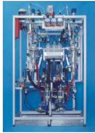
LabKit Reaktorkaskade mit 6 Dosierkreisen und Produktaufbereitung, CIP-Funktion
