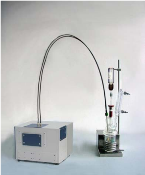
MoleculeEye ATR-Sonde in einem MultiLab 250 ml Reaktor
