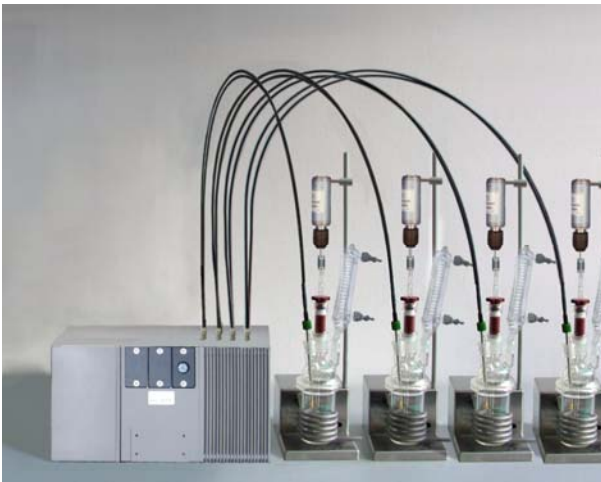
MoleculeEye ATR-Sonden im MultiLab Parallelreaktorsystem.
