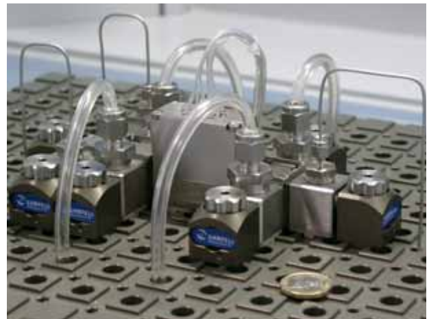
Modulares Mikro-Reaktionssystem: Beispiel für eine einstufige Synthese für heterogene Umsetzungen an Feststoffkatalysatoren
