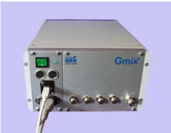
Abb.3 Gasmischstation Gmix41 zur präzisen Gasmischung
