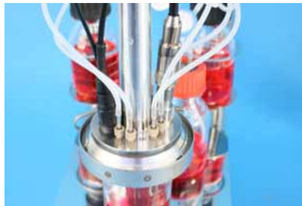
Abb.2: Ansicht des Deckels mit O 2 - und pH-Elektrode, Kondensator, Dosier-, Probenahme- und Erntestutzen.
