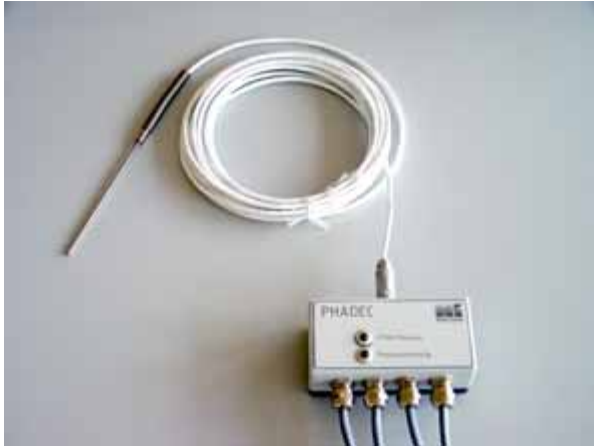
PhaDec Phasengrenzdetektor. Sensor oben links, rechts darunter Auswerteeinheit.
