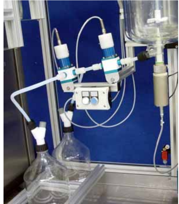
PhaSep Phasentrennmodul mit PhaDec Sensor an einem 5-l Forschungsreaktor. Detektor 6 mm PTFE in automatischem Bodenablass, links davon Steuer- und Trennventil sowie die Auffangbehälter. Zusätzliche Taster zur manuellen Bedienung.
