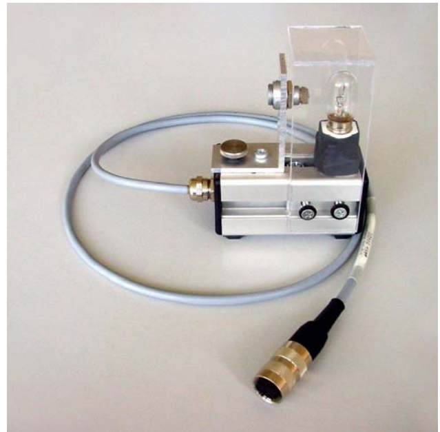
Glühbirne mit Temperatursensor als experimentelle Temperaturregelstrecke
