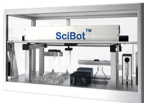
Das Handling verschiedener Pipettenspitzen (250 µl, 1.000 µl, 5.000 µl) sowie der MTP-Kipper oder die Gefäßabdeckung werden durch verschiedene Werkzeuge mit Hilfe eines Werkzeugwechslers realisiert.
