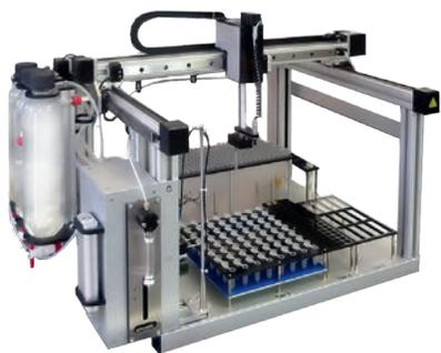
Unsere Syntheseroboter bieten einen großen Funktionsumfang, beispielsweise zur Automatisierung kompletter Syntheseketten, einschließlich der vollautomatischen Präparation von Objektträgern für mikroskopische Analysen.
