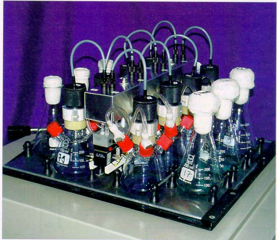
Abb. 1: RAMOS (Respiration Activity Monitoring System), mit acht Messkolben und sechs normale Schüttelkolben für die Probenahme auf einem Standardschütteltablett, in der Mitte des Tablett befinden sich die Ein- und Auslassventile und die Steuerungselektronik
