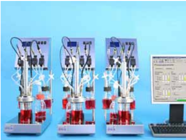
Abb.1 OmniFerm-mini. Beispiel: Dreifach Parallelfementersystem, je Reaktor vier Schlauchpumpen für Dosierung oder Ernte, pH-Regelung, O 2 Messung, individuelle Temperierung.
